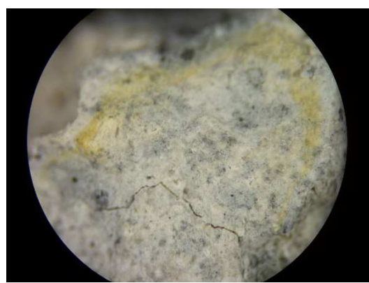
写真 15 白色熱水変質岩片の表面接写
